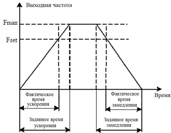
Рис. 6-2 Схема времени ускорения/замедления
