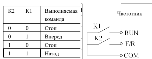
Рис. 6-14 Двухпроводной режим управления 2
